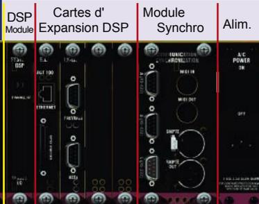
Le chassis LX-300 est livré avec un module LX-DSP d'origine. 4 modules supplémentaires sont disponibles pour augmenter la capacité ou les fonctions. Voir la liste de modules ci-dessous.
